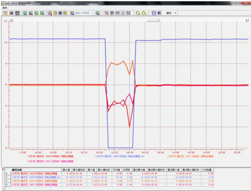
图 4 各段母线电压变化曲线图
